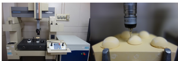
写真 2 : FN 本体(左)と計測用スタイラス部分(右)
