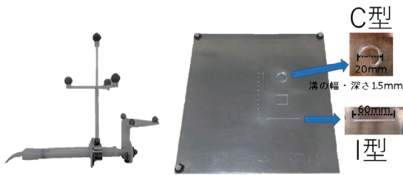
図 4 赤外線反射マークを設置した印象用シリンジと I 型, C 型の溝を付与した金属板
