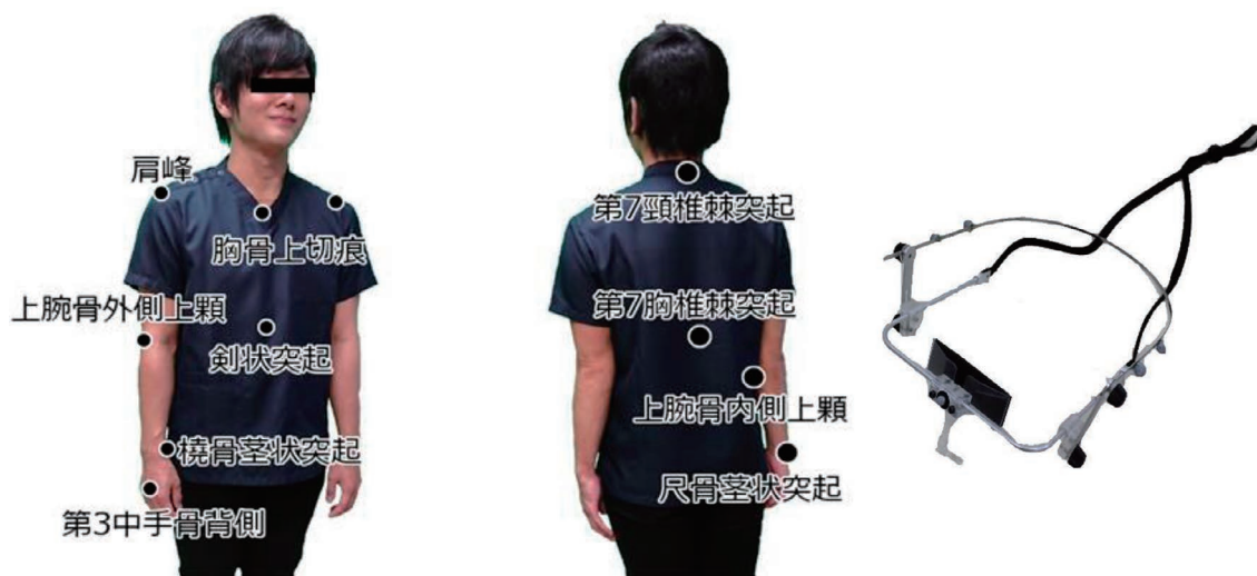
図 2 上肢の赤外線反射マーカ設置位置とヘッドセット
