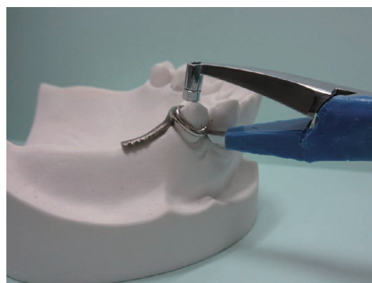
図 3 小型維持力測定装置の測定状況
